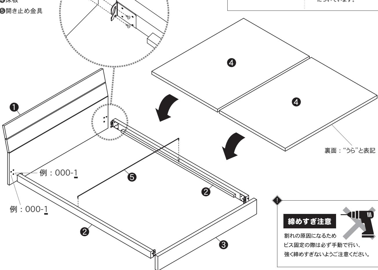
1. ①ヘッドボードと②サイドフレームそれぞれの本体に記載されている番号を合わせて、ダボを穴に差し込み金具の位置を調整しビスを上下軽めに締めておきます。
